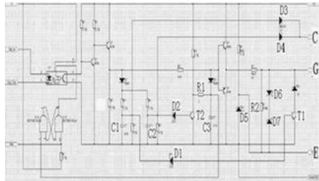
驱动电路如图 4 所示，整个驱动端电路采用 6N137 光耦隔离，单电源供电，通过一个 5V 的稳压管 D5 完成 0V 和-5V 之间的转换，用一个电源实现了正负电源的功能。D6、D7、R2 构成栅极过压保护电路。重要的元件如图中编号所示。D3、D4 是快恢二极管，D1、D2 是稳压值不同的齐纳稳压管。
