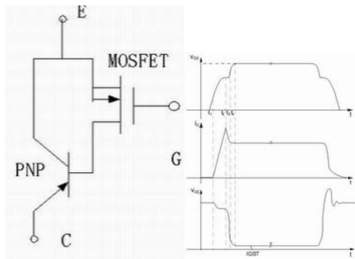
由图 1 所示 IGBT 的等效电路和器件的内部结构可知，IGBT 的开关控制是通过和 MOSFET 类似的栅极结构来完成的，因此 IGBT 和 MOSFET 的开关过程大致相似。图 2 为 IGBT 硬开关时  $V_{GE}$ 、 $I_{CE}$  和  $V_{CE}$  的波型。开通时，当  $V_{GE}$  达到开通门限后，到  $t_2$  时间， $I_{CE}$  达到最大值， $V_{CE}$  下降过程中，由于和 MOSFET 一样的密勒电容  $CGC$  的作用，栅极电压基本恒定，延缓了 IGBT 的开通过程，当  $V_{CE}$  下降结束， $I_{CE}$  达到稳态值， $CGC$  作用消失， $V_{GE}$  以较快的上升率达到最大值。为了降低此效应，应该使栅极驱动源的内阻足够小，增加流经  $CGC$  的电流，加快开通速度。
