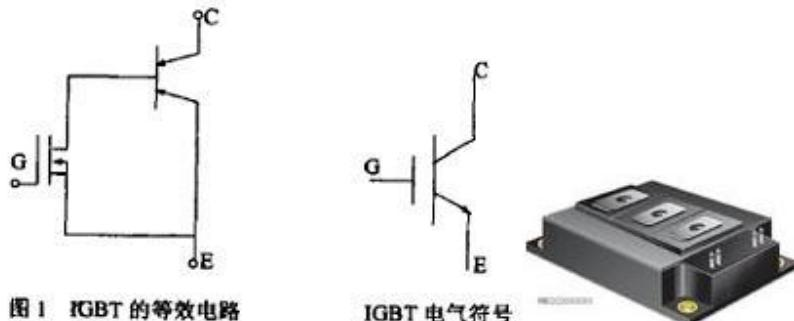
图 1 IGBT 的等效电路
